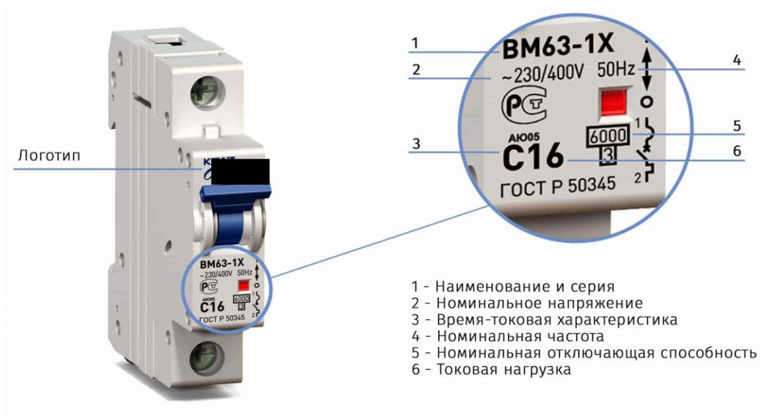
Рисунок 2. Пример маркировки АВ
