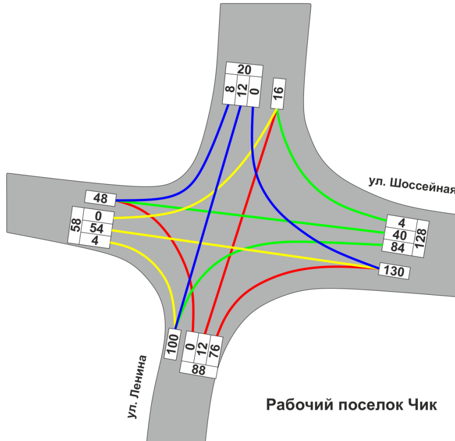
Рисунок 1.51 – Интенсивности транспортных потоков (ед/ч) на пересечении ул. Шоссейная и ул. Ленина рп. Чик
