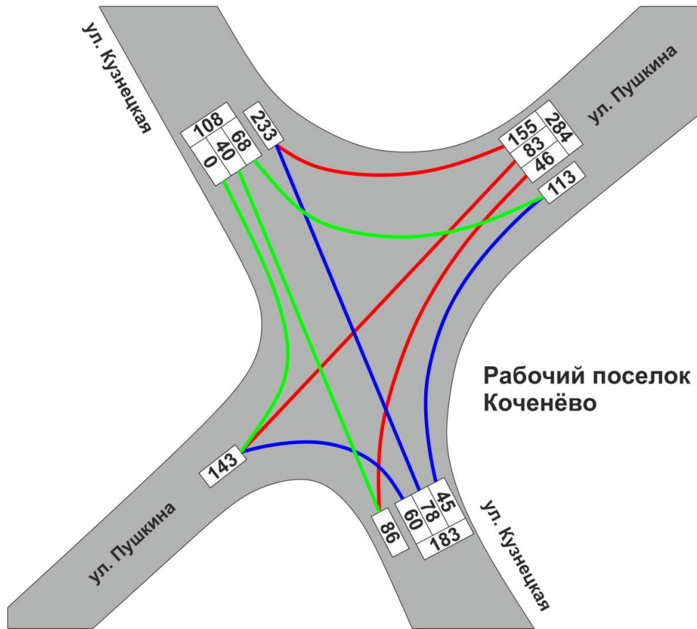
Рисунок 1.60 – Интенсивности транспортных потоков (ед/ч) на пересечении ул. Кузнецкая и ул. Пушкина рп. Коченево
