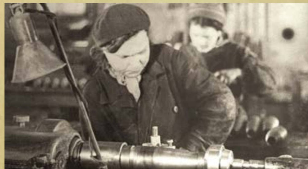
Обработка корпуса артиллерийского снаряда для фронта силами женщин на заводе «Сибметаллстрой». 1941–1945 годы
