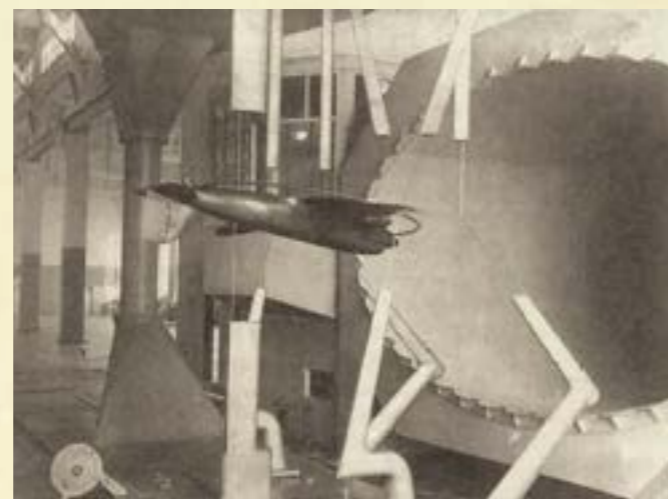
Продувка модели самолета в аэродинамической трубе Т-203
