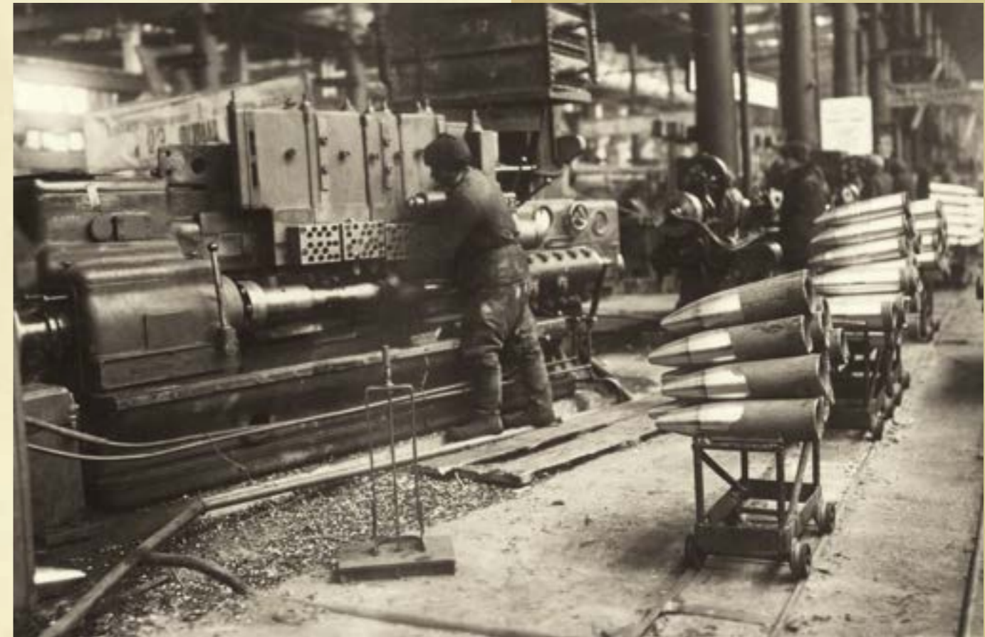
Поточное производство 45-мм осколочно-трассирующего снаряда на заводе № 65 имени Сталина. Общий вид ленточного конвейера стопроцентного контроля качества корпуса
