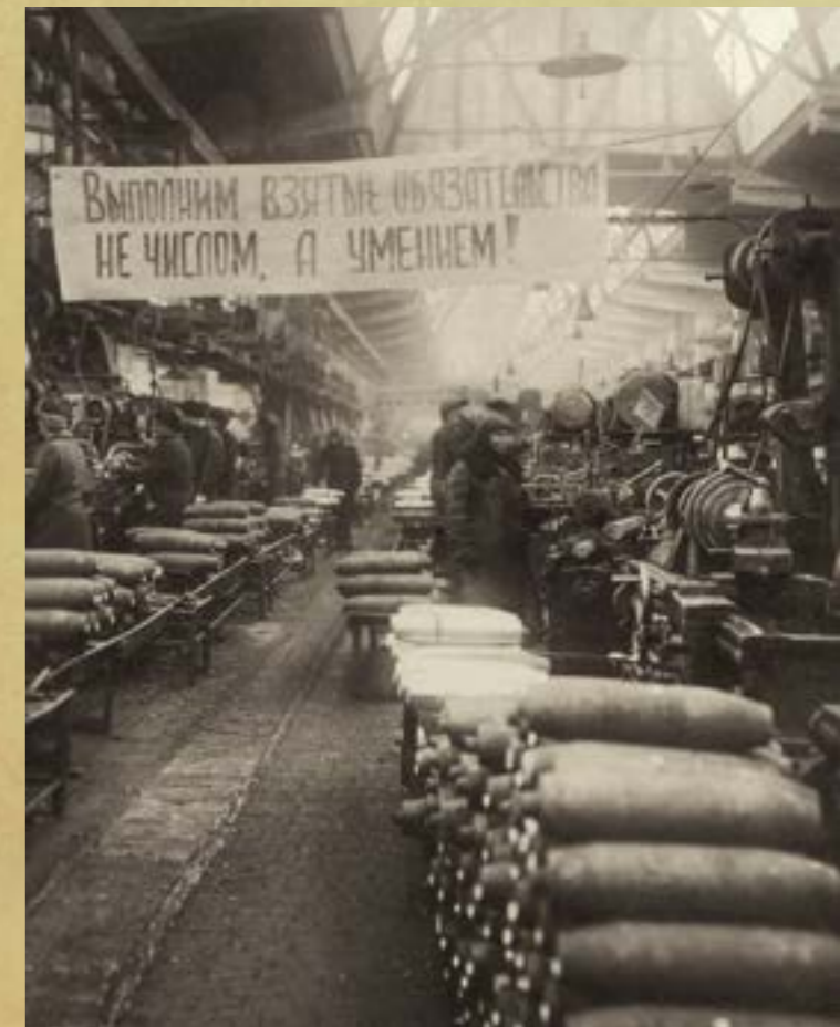
Поточное производство на заводе № 65 имени Сталина. Производство 122-мм осколочно-фугасной гаубичной гранаты. Общий вид потока механической обработки корпуса чистового предела
