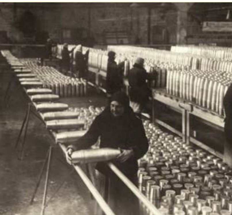
Поточное производство на заводе № 65 имени Сталина. Производство 122-мм осколочно-фугасной гаубичной гранаты. Общий вид потока чернового передела
