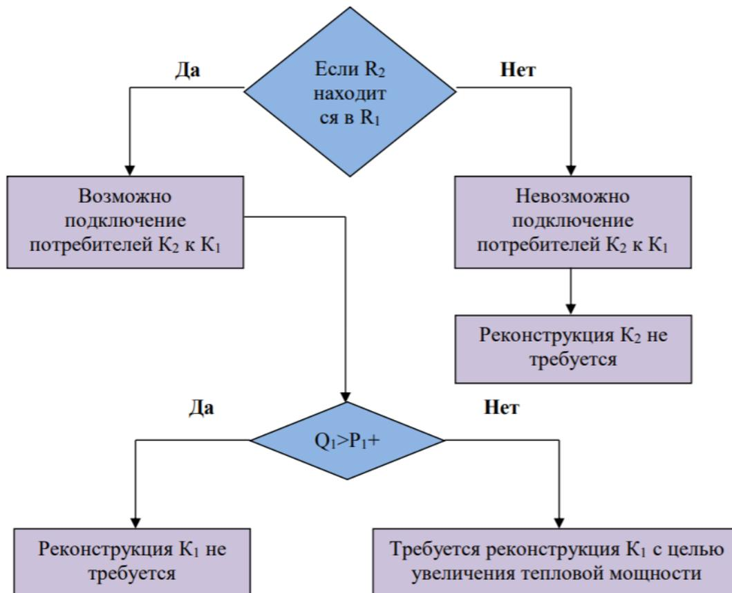
Рисунок 2.6 – Блок-схема обоснования реконструкции котельной  $K_1$ ,  $K_2$  – Котельные №1 и №2;  $R_1$ ,  $R_2$  – радиусы эффективного теплоснабжения котельной №1 и котельной №2;
